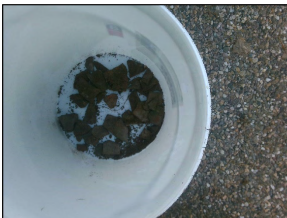
Foto 5: Asbestverdacht materiaal Proefgat G23 (puinpad PA2)
