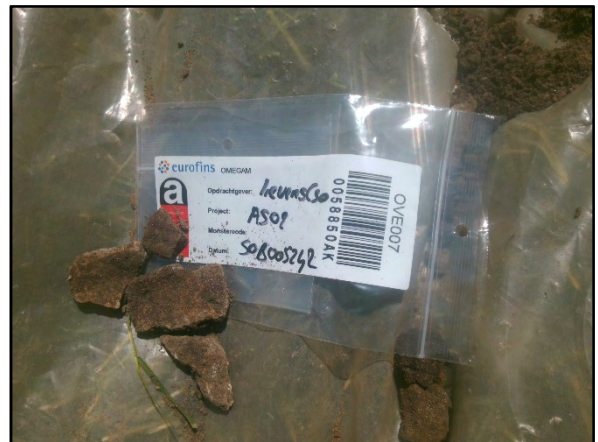
Foto 2: Asbestverdacht materiaal G02
