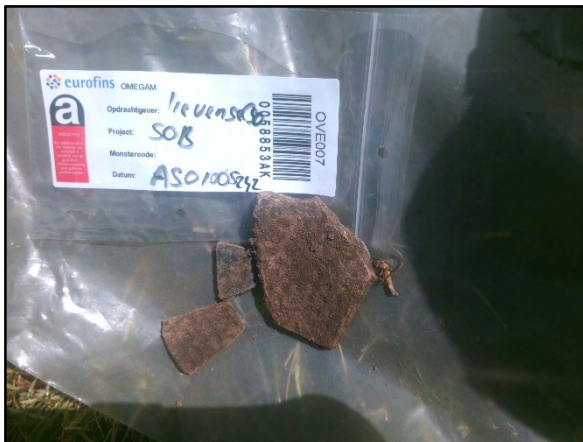
Foto 1: Asbestverdacht materiaal G01
