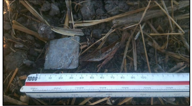
Foto 14: Asbestverdacht materiaal op maaiveld ST3 (2)
