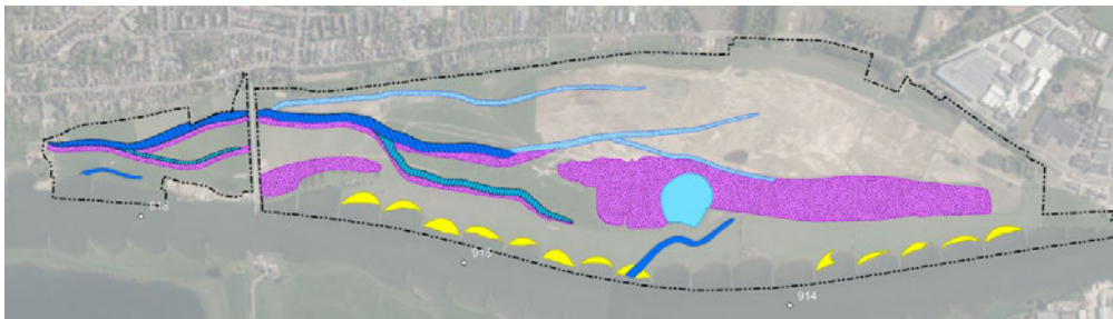
Figuur 2: Contouren KRW-maatregelen Elster Buitenwaard inclusief voorliggende planwijziging, donderblauw: centrale geul en rivier(kwel)geulen, lichtblauw kwelgeul en afwateringsgeulen en in lichtblauw verontdiepte zandwinplas, paars: moeras en geel: zandstrandjes als gevolg van natuurvriendelijke oevers.
